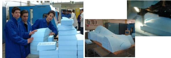
Usinage du modèle par CFAO
